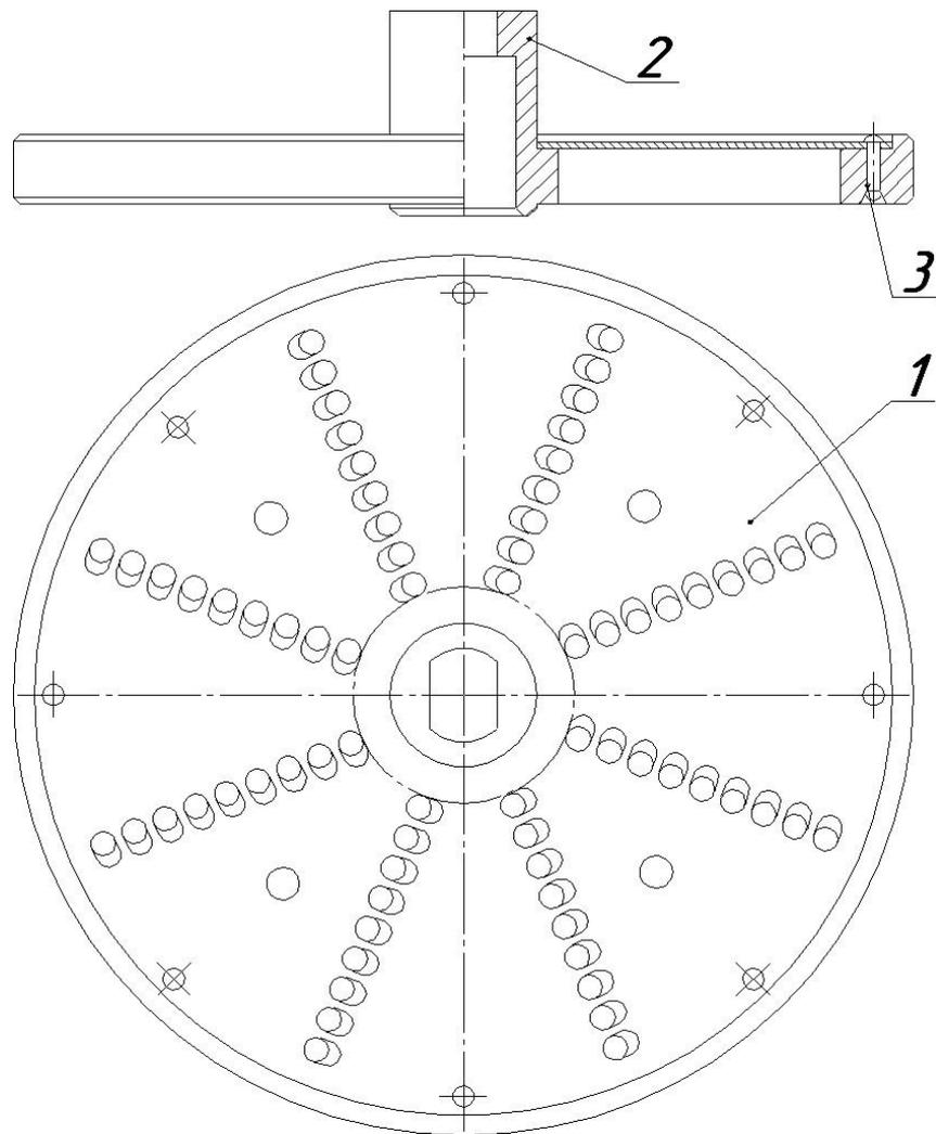
**Рисунок – 9 Диск шинковочный:**
