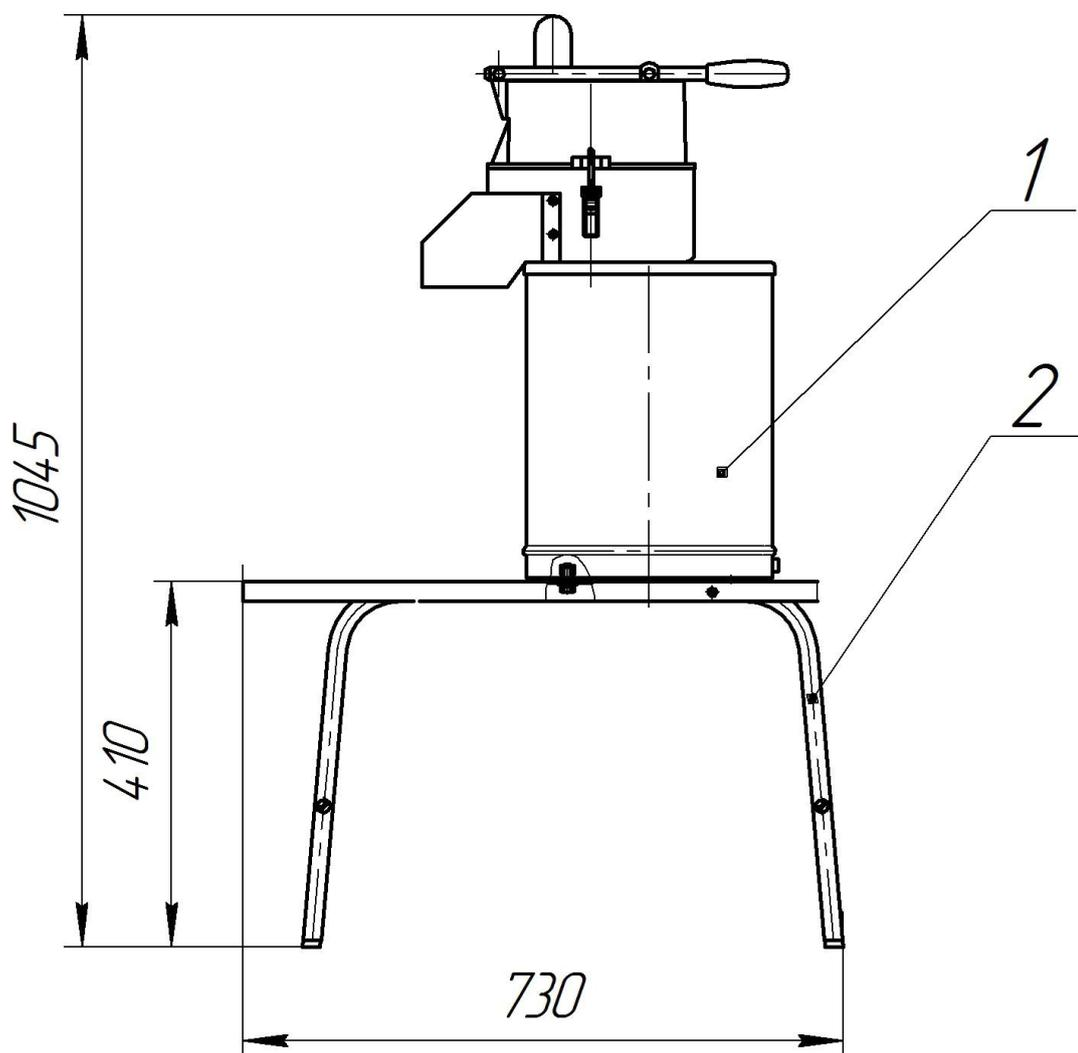
**Рисунок -1** Машина овощерезательно-протирочная
