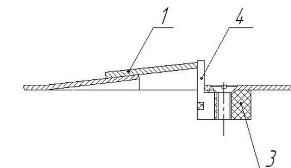
**Рисунок – 5** Нож комбинированный 10x10 мм:
