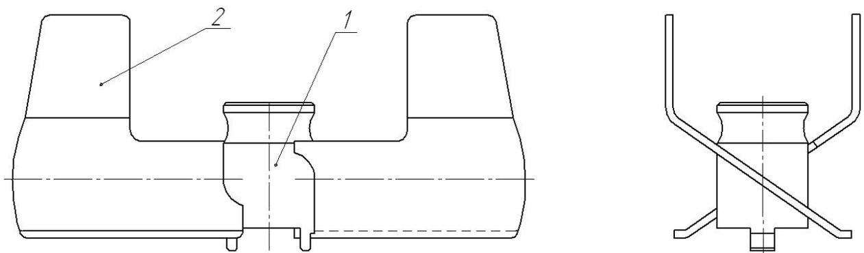
**Рисунок – 10 Ротор лопастной:**
