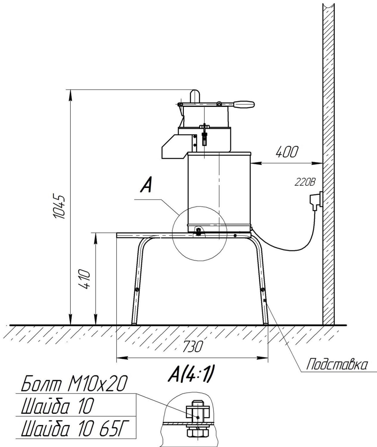
Рисунок – 14 Схема установки на подставке ОМ-350/380
