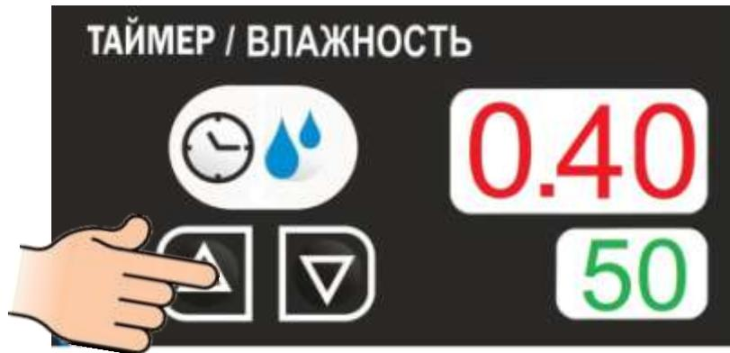
Повторное нажатие кнопки «
